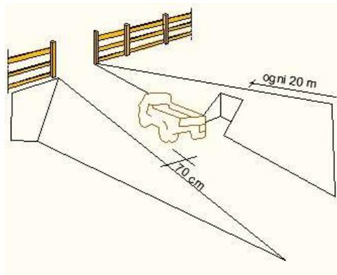
I viottoli e le scale con gradini ricavati nel terreno o nella roccia devono essere provvisti di parapetto nei tratti prospicienti il vuoto quando il dislivello superi i 2.00 metri
